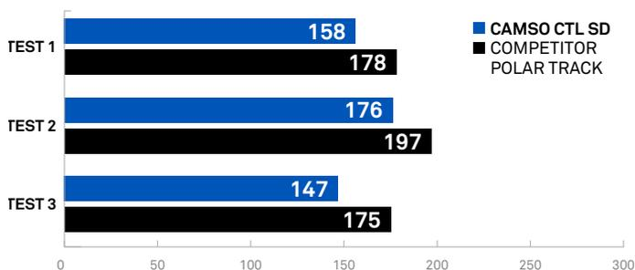
Per tutto il test, i cingoli Camso hanno dimostrato spazi di frenata sul ghiaccio del 13% inferiori rispetto al concorrente assicurando una migliore tenuta e un minore slittamento.
