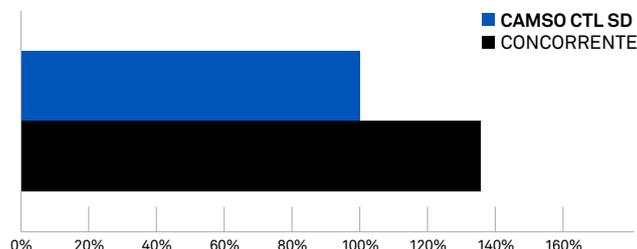
Un test ha mostrato che i cingoli Camso offrono una resistenza al rotolamento inferiore del 36% rispetto agli altri cingoli premium della concorrenza.
